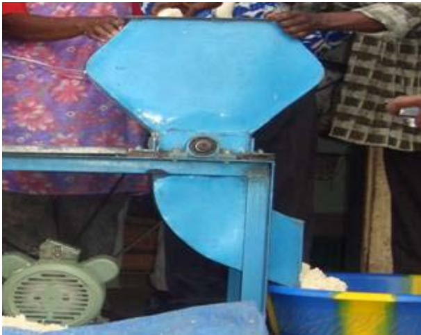
Photo 27. Râpage des racines tubéreuse de manioc
