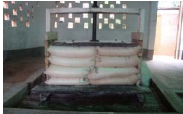
Photo 25. Pressage de la pâte des racines tubéreuses de manioc.
