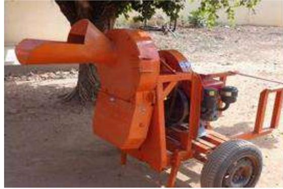
*Hacheuse de fourrage avec moteur intégré*
