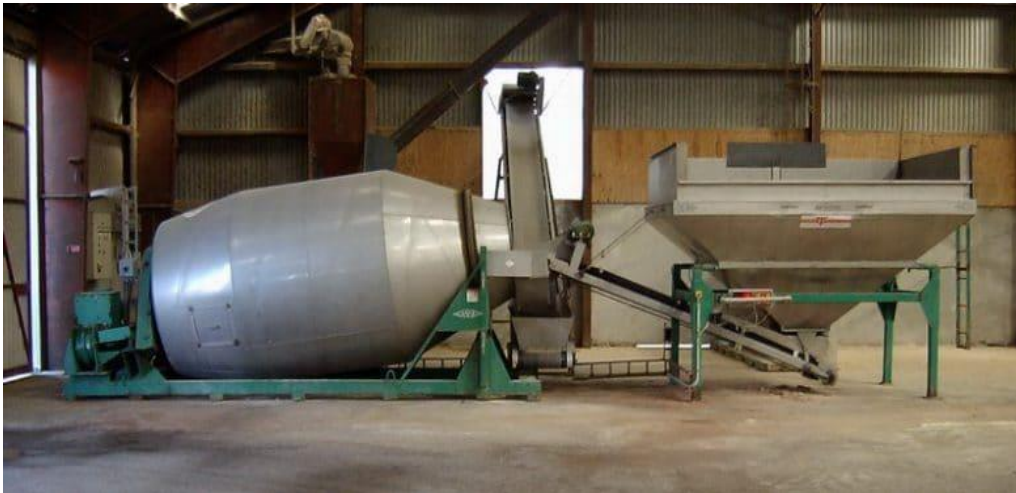
Équipement utilisé dans le mélange d'engrais à plus petite échelle
