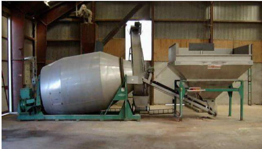
*Équipement utilisé dans le mélange d'engrais
