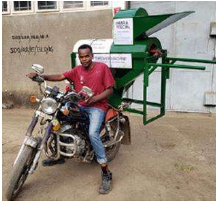
Les petites batteuses sont portables, ce qui permet de fournir des services au niveau de la ferme
