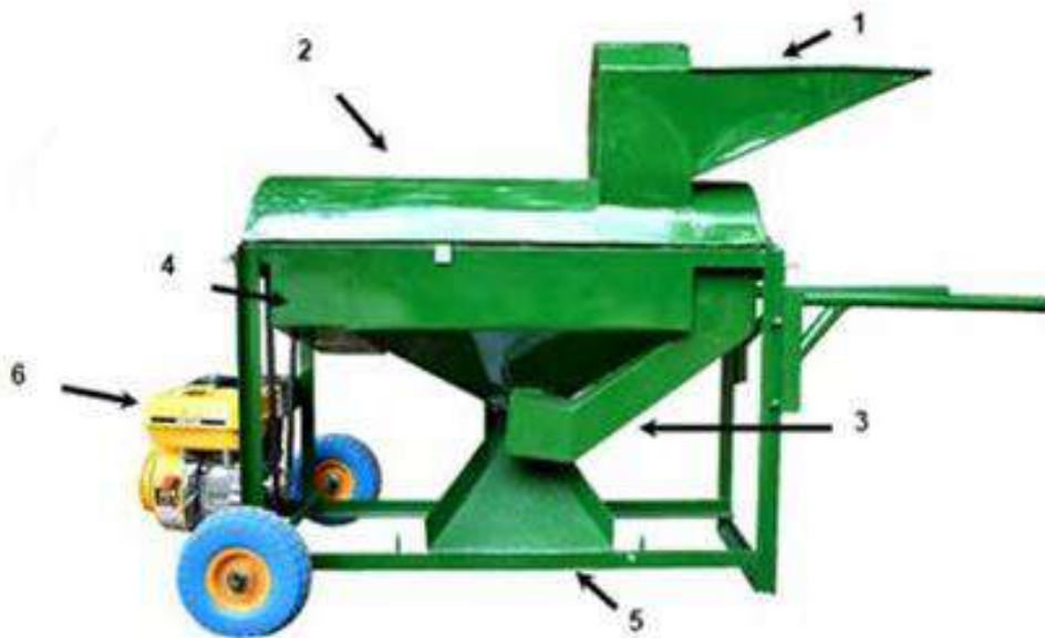
La batteuse Imara Tech Multi-crop se compose d'une 1) goulotte d'alimentation, 2) chambre de battage, 3) goulotte de sortie, 4) souffleur, 5) goulotte de collecte des graines, et 6) moteur à essence
