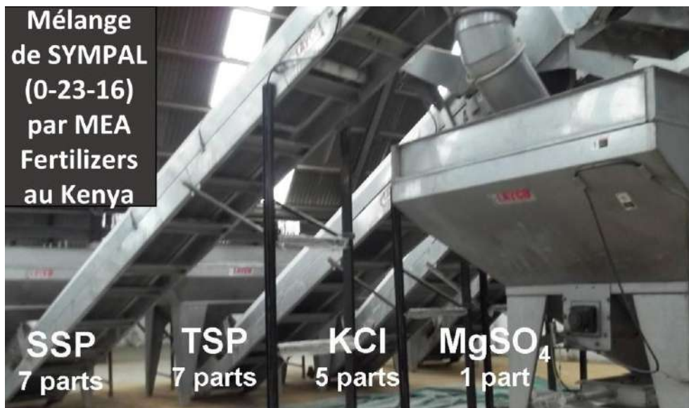
Un mélangeur multicanaux en fonctionnement chez 'MEA Fertilizers' utilisé pour produire du SYMPAL pour les légumineuses à grain au Kenya
