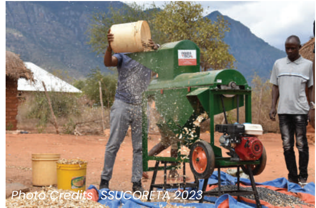
Picha Na. 13: Mashine bora ya kupura Alizeti kutoka kampuni ya Imara Technology Ltd, Arusha, Tanzania
